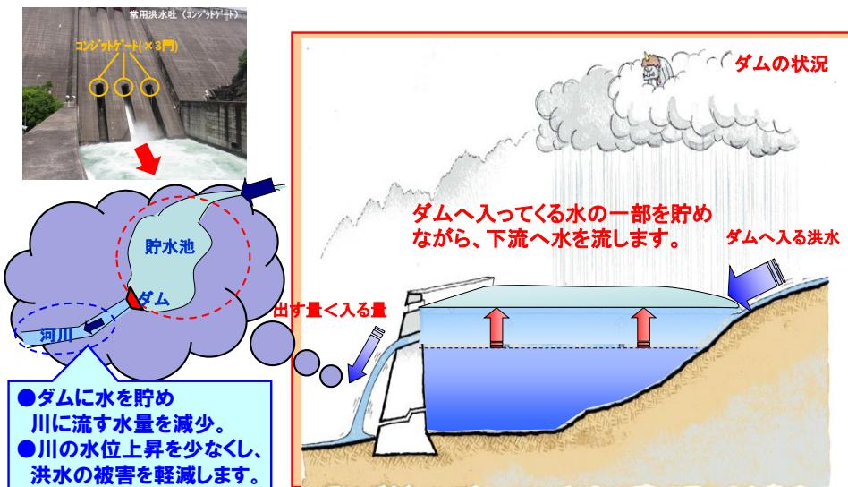
図 2-6 防災操作（＝洪水調節）のイメージ図
