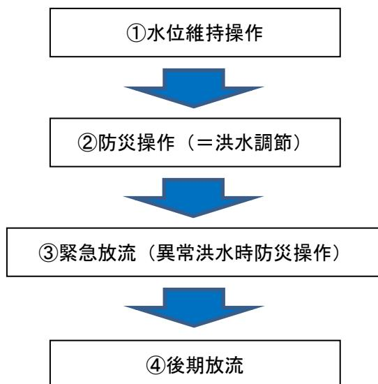
図 2-4 弥栄ダムの防災操作の手順フロー
