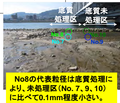
図 2.2.3-4 干潟再生試験区施工直後 (H22.3.2) の粒度分布調査結果
