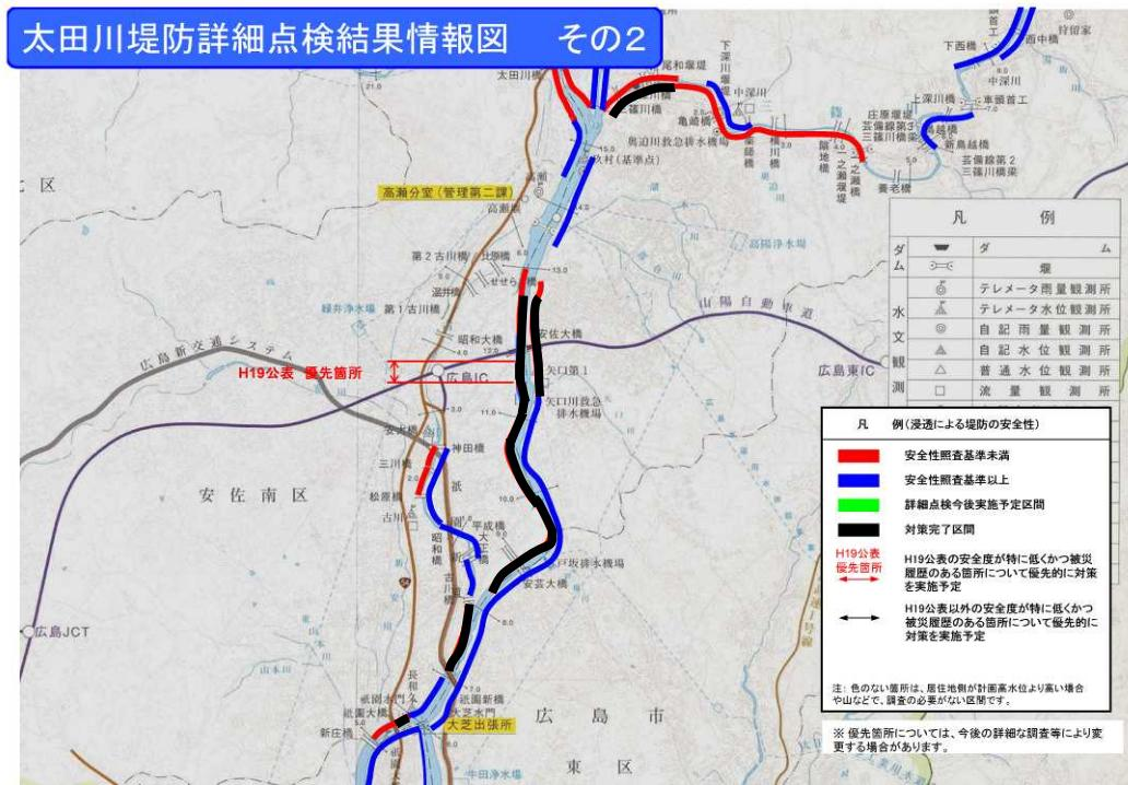
図 3-4-3 堤防詳細点検結果及び対策状況（太田川下流・古川）
