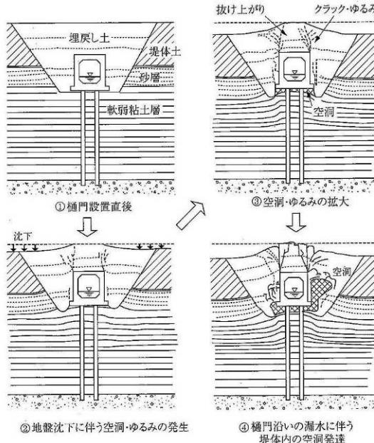
図 3-4-5 樋門の周辺堤防の空洞・クラック発生過程
