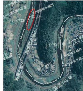
図 5-2-3 比高差が拡大によりみお筋が固定化し、樹木が繁茂している箇所
