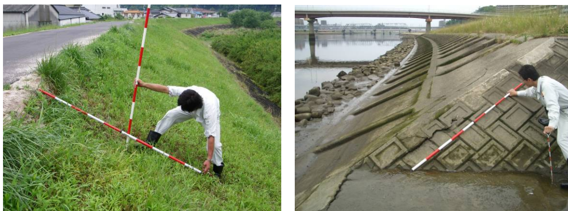
図 5-3-4 堤防点検の状況
