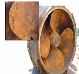
排水ポンプの腐食(例)
