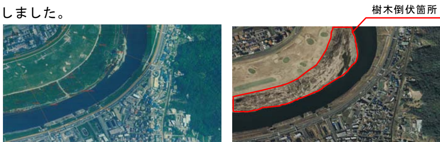
出水前 H12 年撮影 出水後 H18 年撮影 図 3.1.12 太田川下流部 9.0k 付近の樹木倒伏状況
