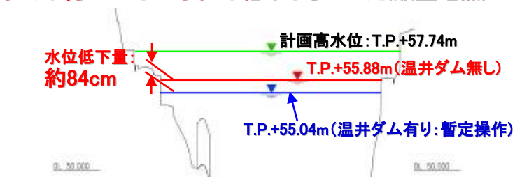
温井ダムの有無による水位の比較(昭和47年7月洪水: 飯室地点) 注)横断面は29.4k地点
