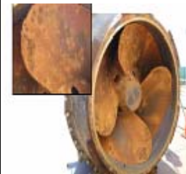
排水ポンプの腐食(例)
