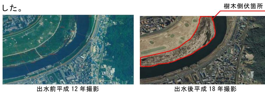
図 3.1.11 太田川下流部 9.0k 付近の樹木倒伏状況
