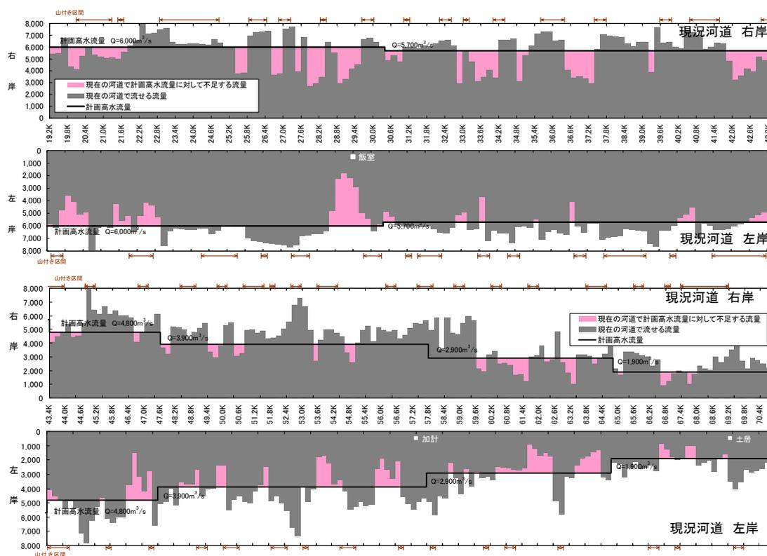
図 3.1.39 現況流下能力図(中流部)
