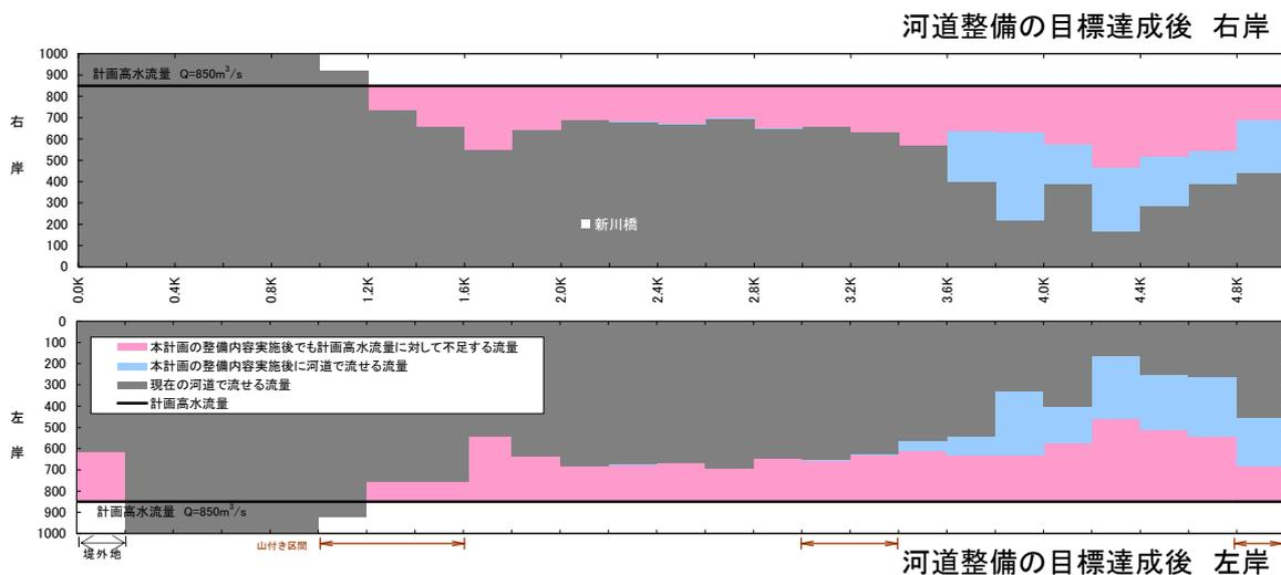
図 5.1.25 流下能力図 (支川根谷川)
