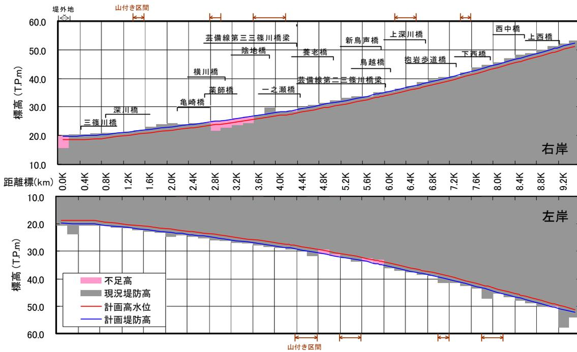
図 3. 1. 46 堤防高縦断図(支川三篠川)
