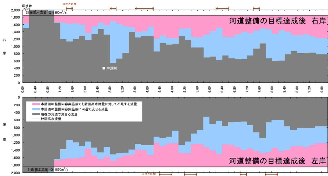
図 5.1.20 流下能力図（支川三篠川）
