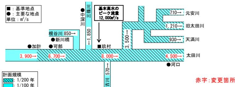
図 2.2.4 工事实施基本計画と河川整備基本方針の流量配分
