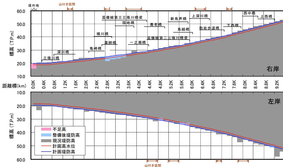
図 5.1.21 堤防高縦断面図（支川三篠川）
