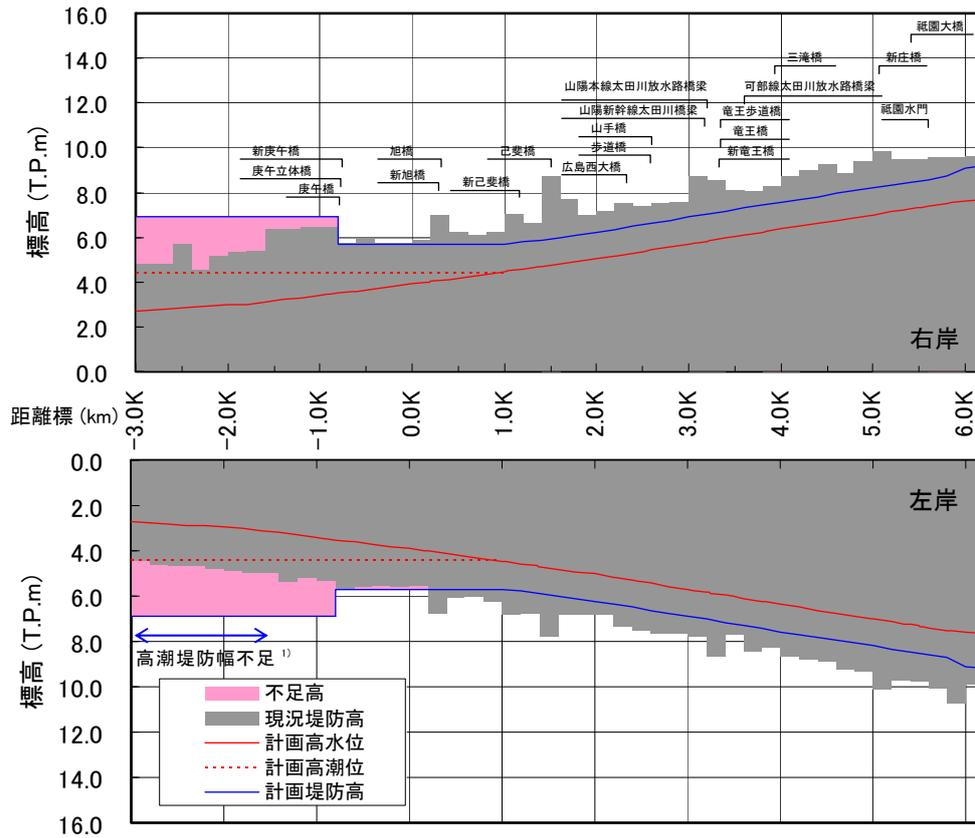
図 3.1.21(1) 堤防高縦断図(太田川放水路)<sup>1)</sup>
