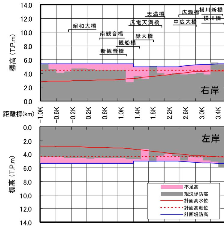
図 3.1.21(2) 堤防高縦断図(天満川)
