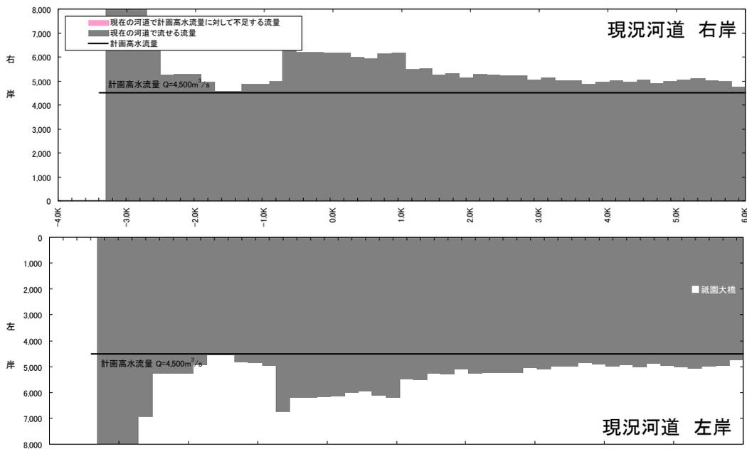
図 3.1.19 現況流下能力図(太田川放水路)
