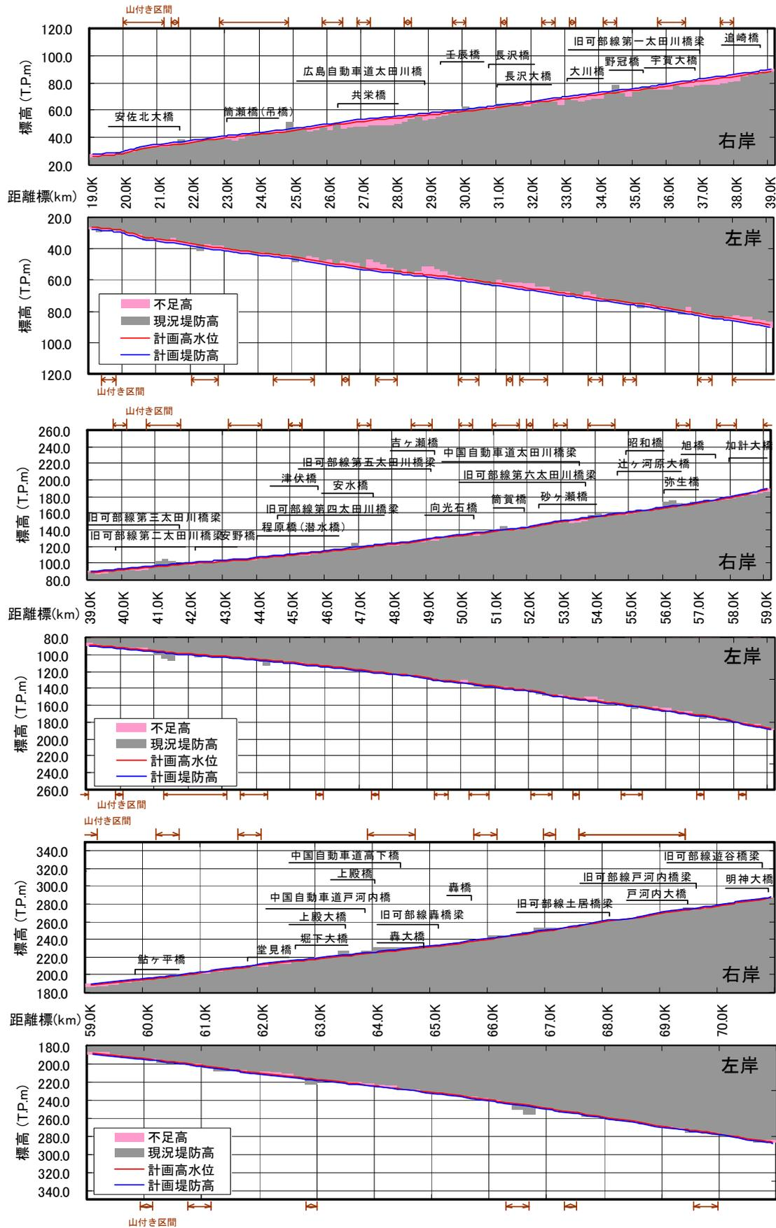
図 3.1.41 堤防高縦断面図(中流部)
