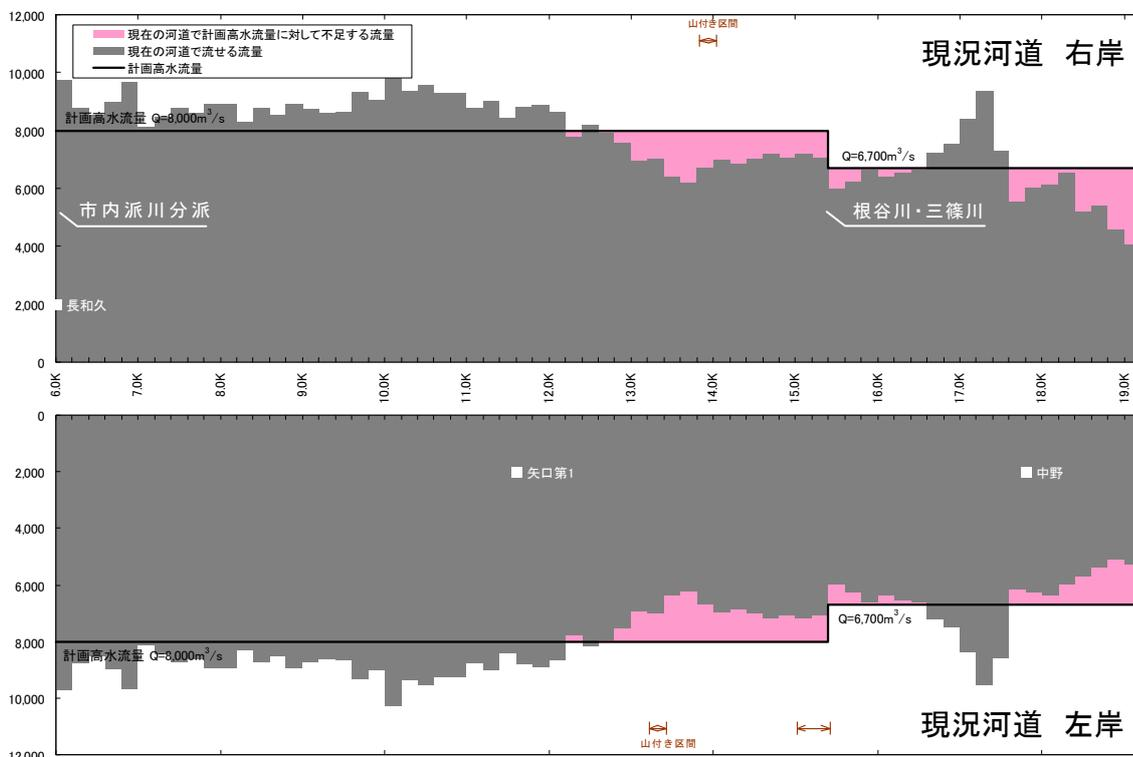
図 3.1.30 現況流下能力図(下流部)
