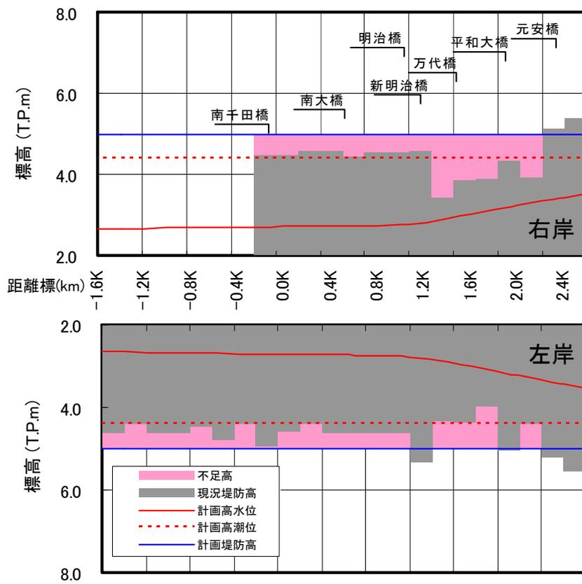
図 3.1.21 (4) 堤防高縦断図(元安川)
