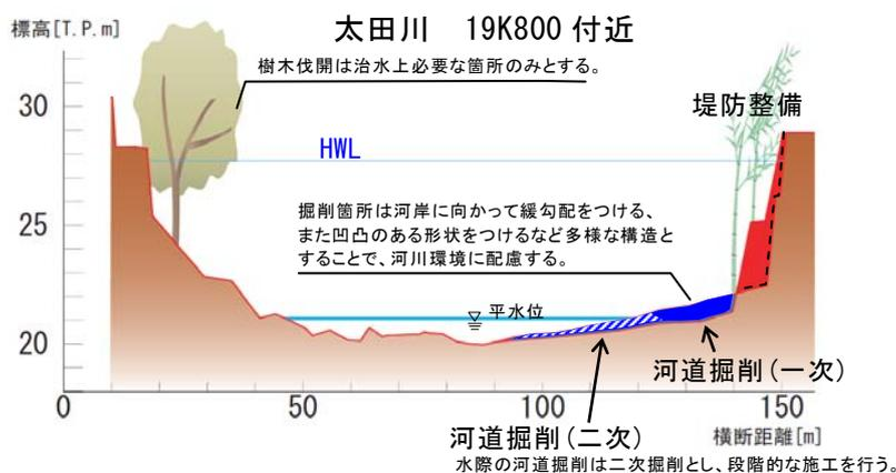
図 5.1.14 中流部の施工断面のイメージ図
