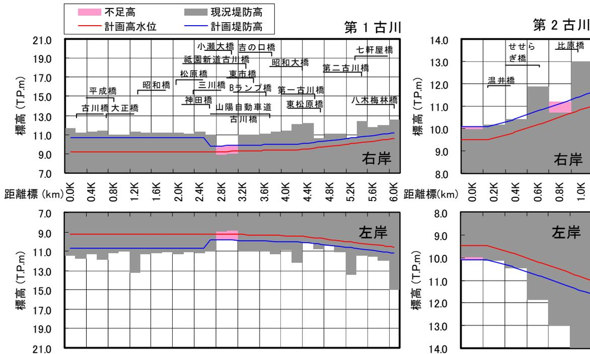
図 3.1.34 堤防高縦断図(第1古川、第2古川)
