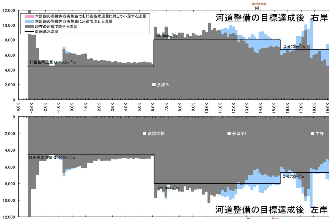
図 5.1.3(1) 流下能力図(太田川放水路・下部部)
