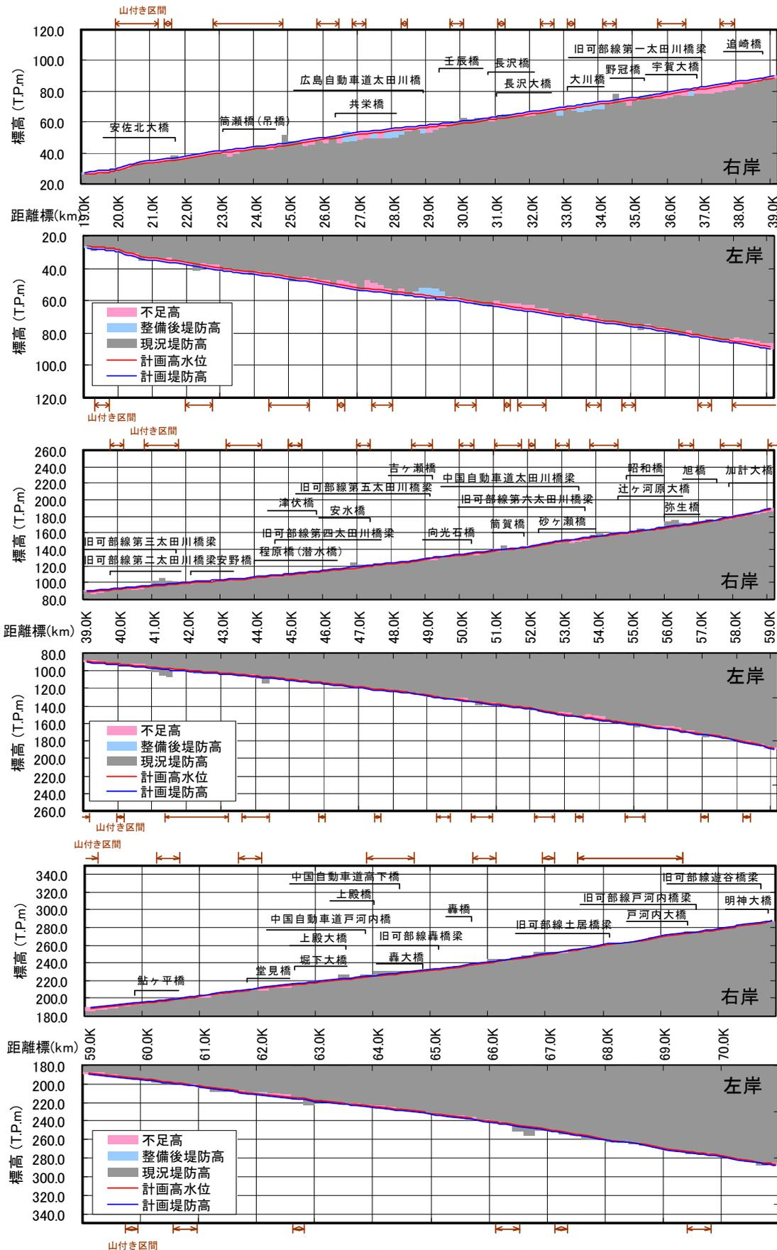
図 5.1.17 堤防高縦断面図 (中流部)
