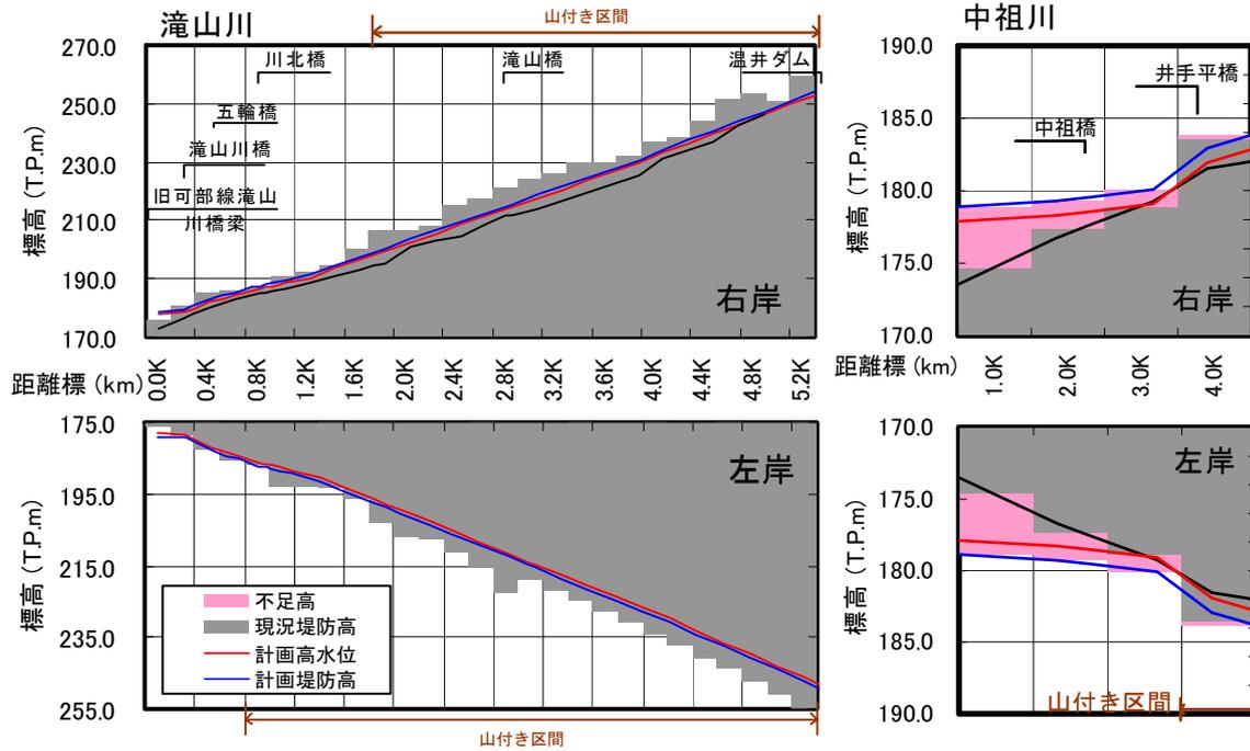
図 3.1.55 堤防高縦断図(支川滝山川、中祖川)
