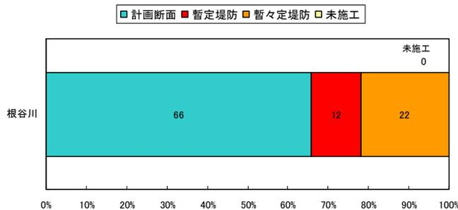
図 3.1.52 堤防整備率(支川根谷川)
