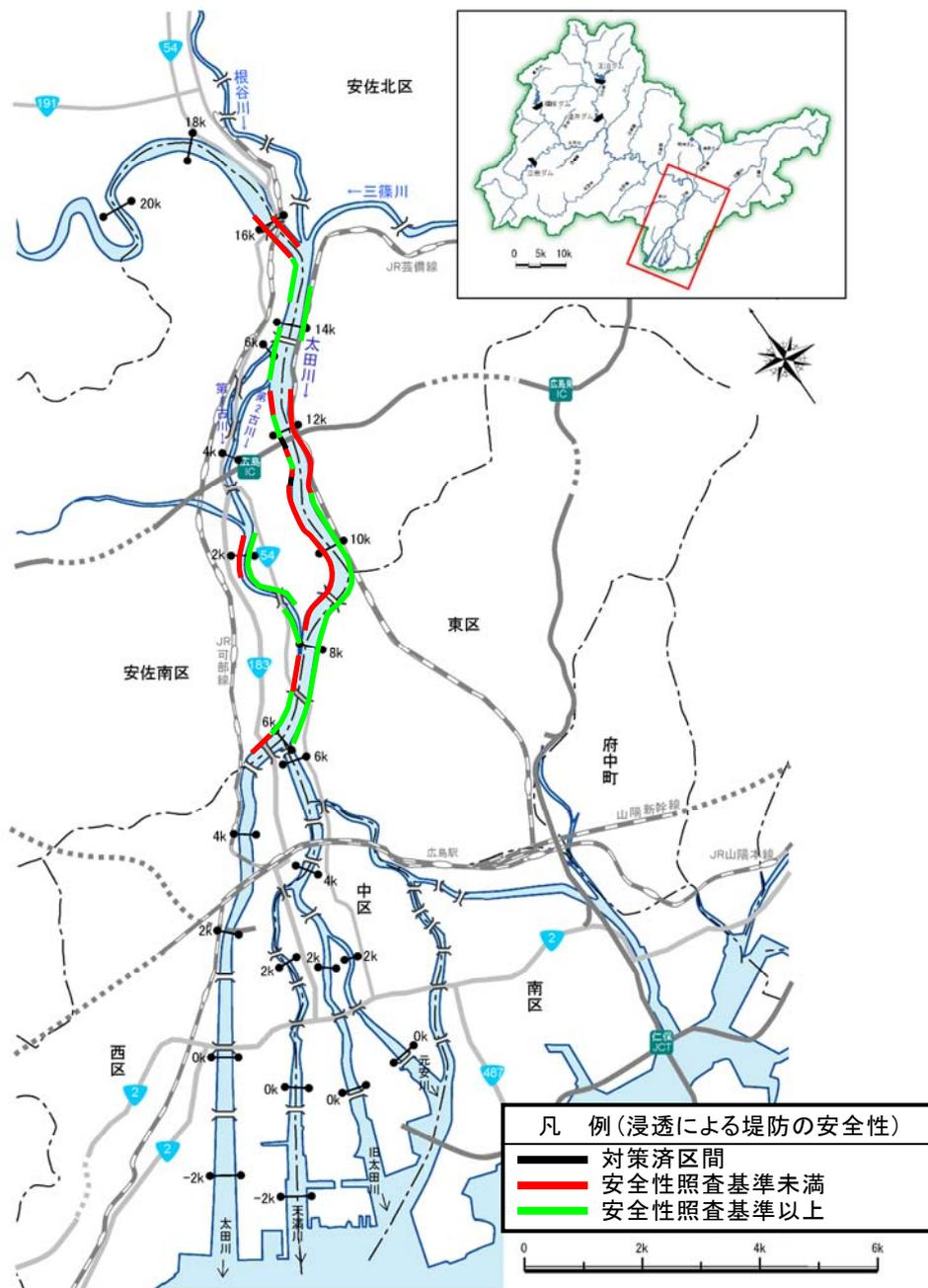
図 3.1.36 堤防の浸透に対する安全性の状況
