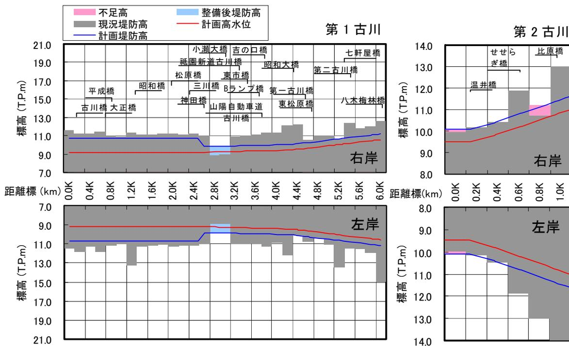
図 5.1.30 堤防高縦断図 (第1古川、第2古川)
