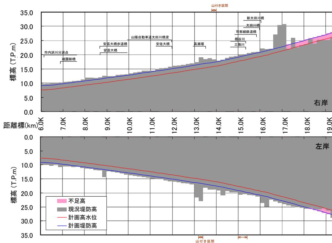
図 3.1.31 堤防高縦断図(下流部)
