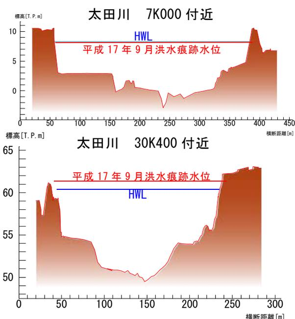
図 3.1.2 平成 17 年 9 月洪水の痕跡水位
