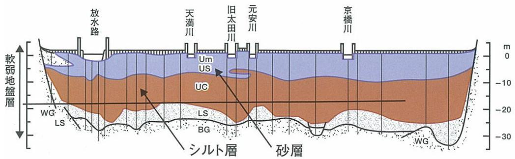
図 3.1.23 下流デルタ域の地質断面図
