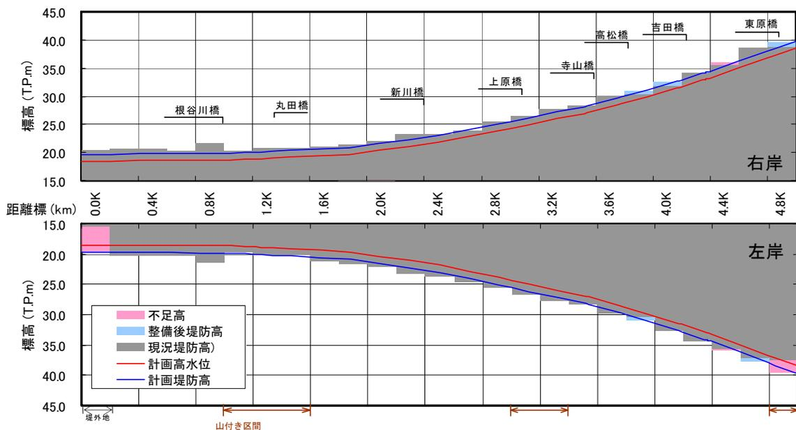
図 5.1.26 堤防高縦断図 (支川根谷川)
