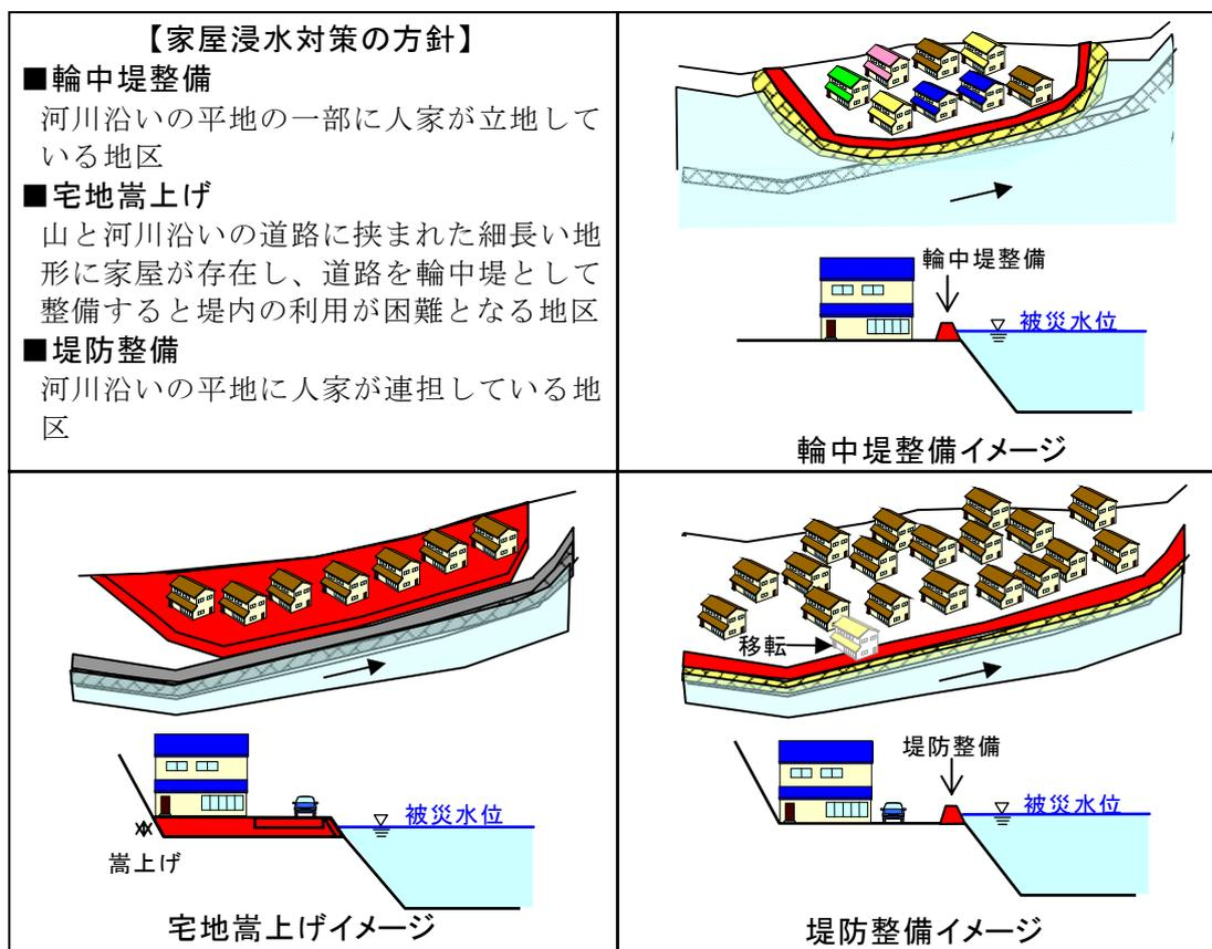
図 5.1.13 家屋浸水対策のイメージ図
