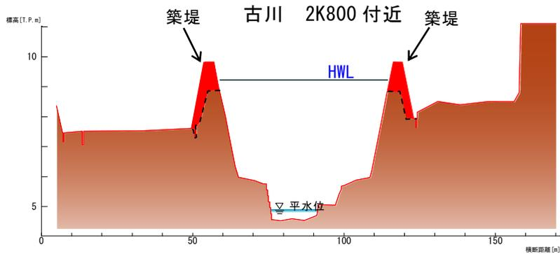
図 5.1.28 支川古川の施工断面のイメージ図
