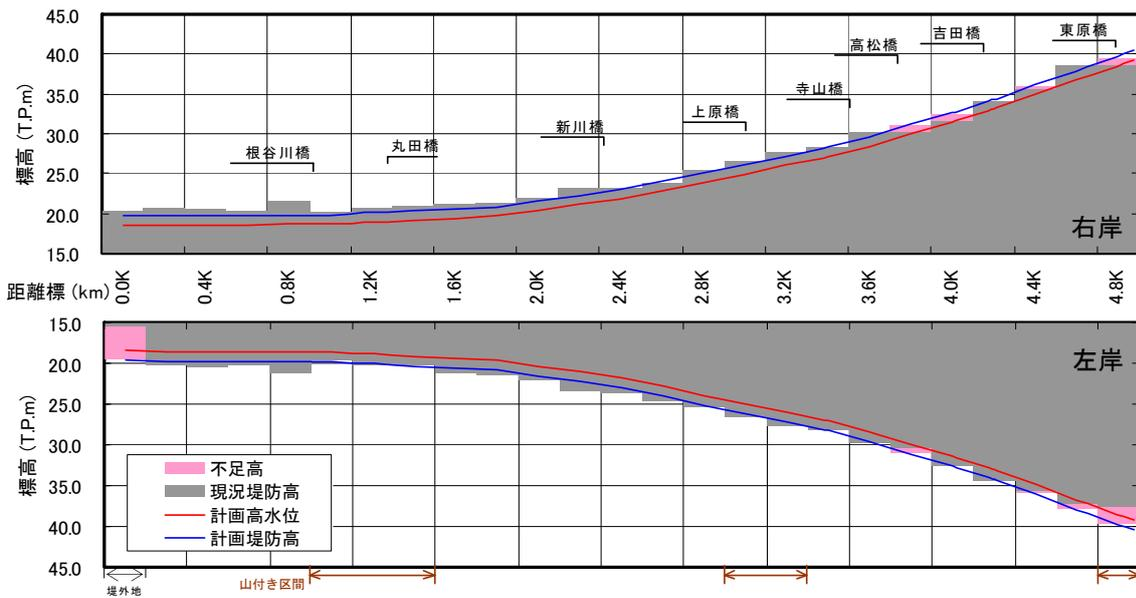
図 3.1.51 堤防高縦断面図(支川根谷川)
