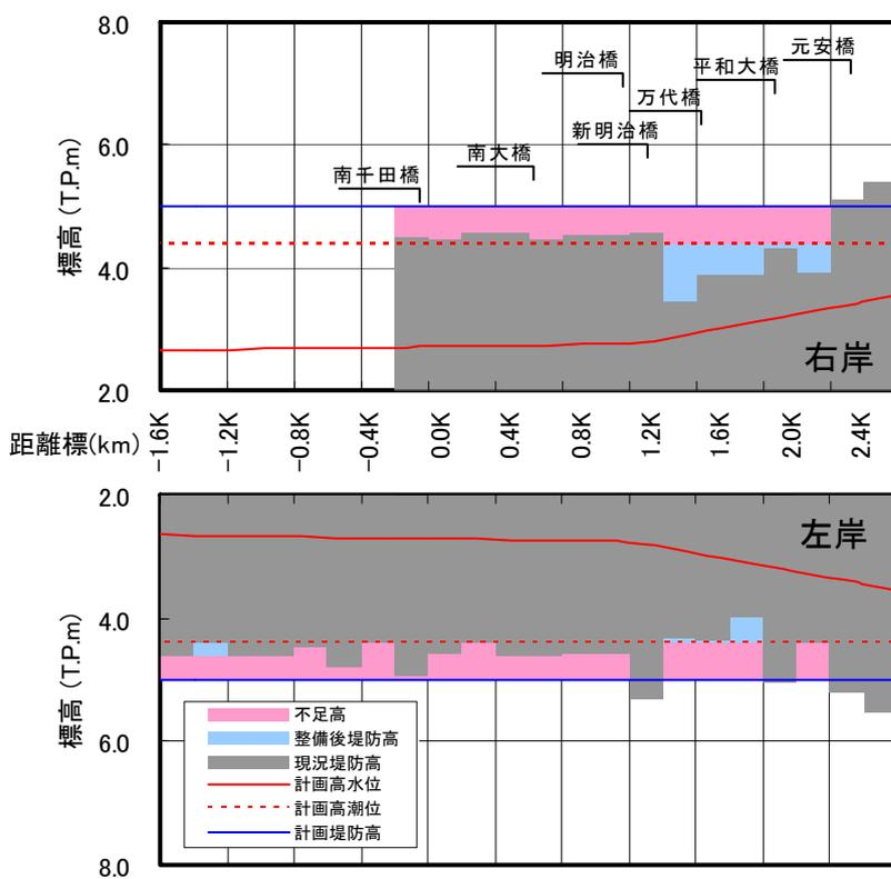
図 5. 1. 4 (4) 堤防高縦断図 (元安川)
