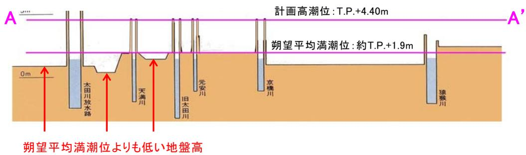
図 3.1.25 下流デルタ域の横断面図
