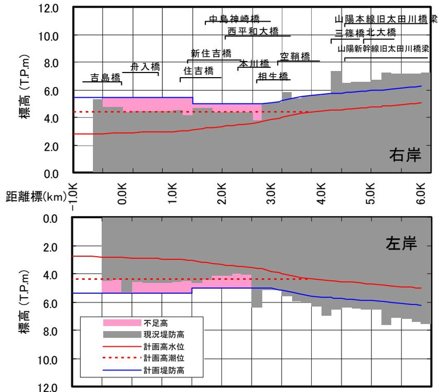
図 3.1.21 (3) 堤防高縦断図(旧太田川)
