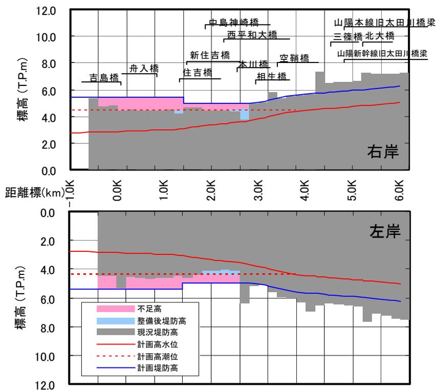
図 5. 1. 4 (3) 堤防高縦断図 (旧太田川)
