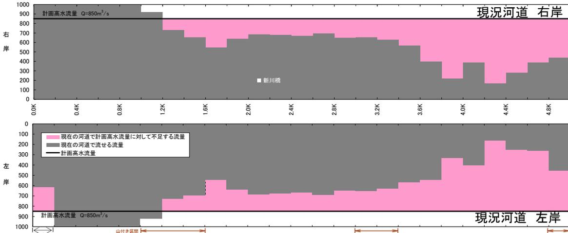
図 3.1.50 現況流下能力図(支川根谷川)
