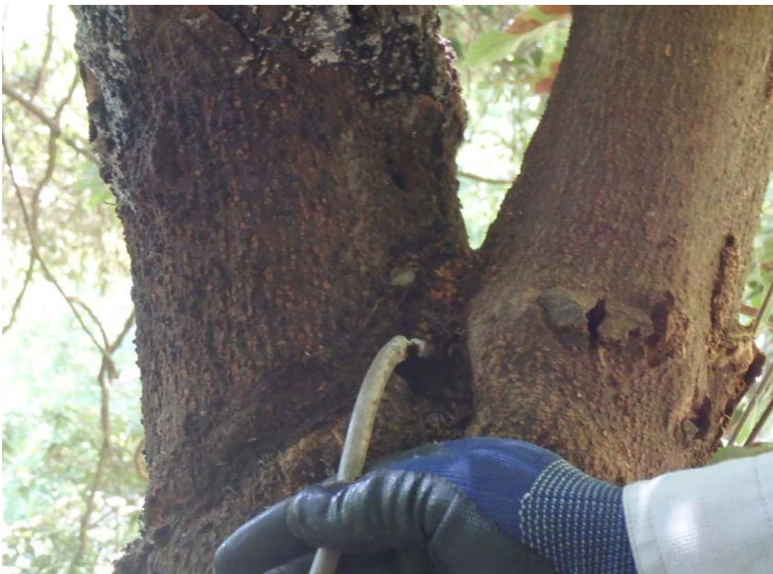
通信線の破断場所（拡大写真）
