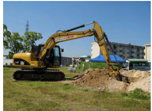
写真：遠隔操縦装置「ロボQ」を装着した建設機械
