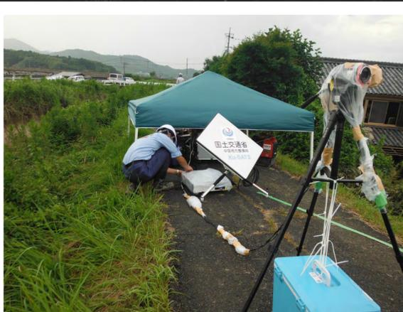
衛星通信装置(Ku-SAT II)
