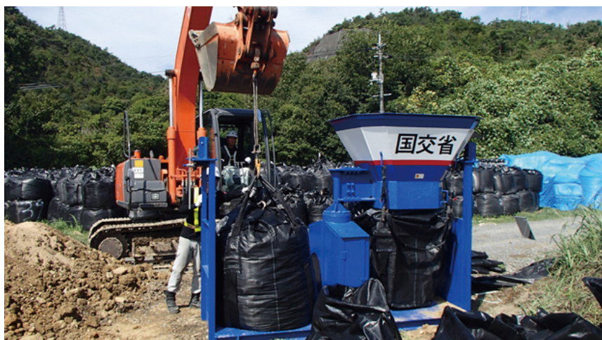
大型土のう製造機（九州地方整備局貸与品）
