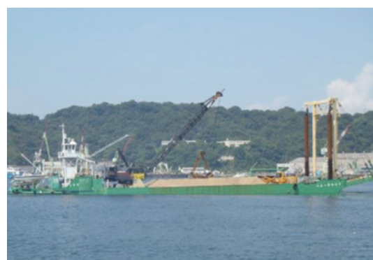
土運船による海上運搬
