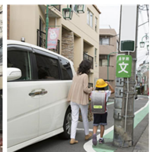
<歩行の支障となる電柱の事例>
