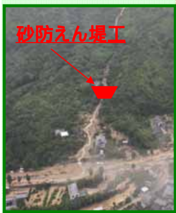
神里川(かみさとがわ) 砂防えん堤工 1基(高さ9m)
