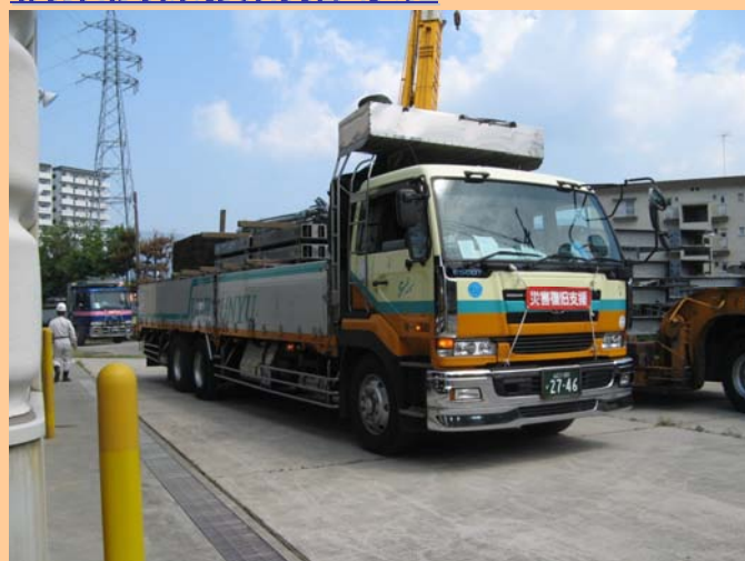
▲ 応急組立橋梁 積込・輸送 (中国技術事務所)
