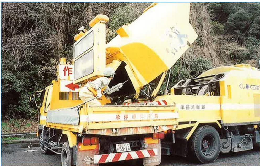
路面清掃車（真空式・リアリフトダンプ式）の塵埃積み替え状況
