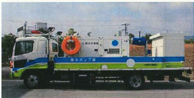
排水ポンプ車
