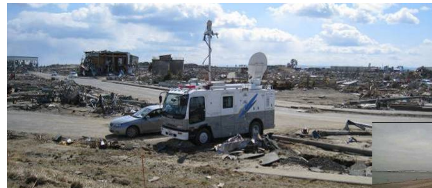
被災したCCTVカメラの機能を代替する衛星通信車
