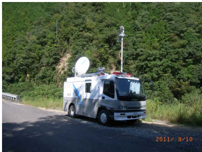
移動衛星通信車の設置（奈良県十津川村栗平）
