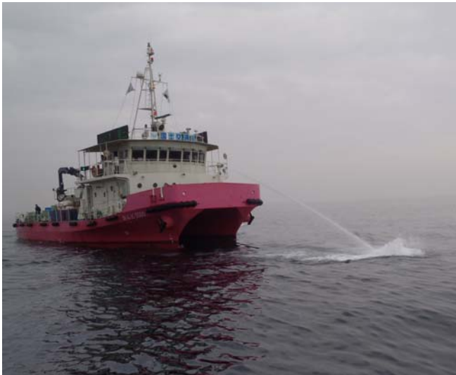
海面清掃船「おんど 2000」防除作業状況
