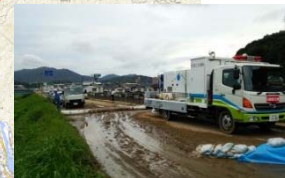
排水ポンプ車の派遣 【H26.8広島豪雨災害】
