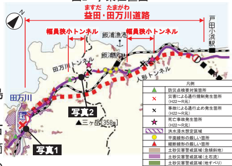
図3 通行止め発生状況、事故発生状況
