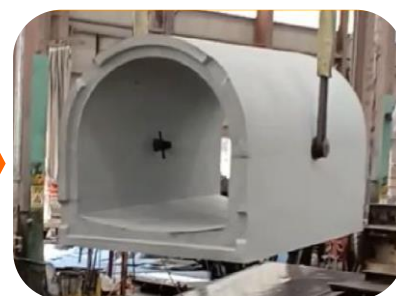
アーチカルバートの製作
