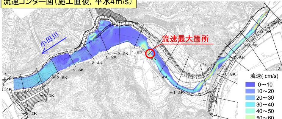
流速コンター図(施工直後, 平水4m 3 /s)
