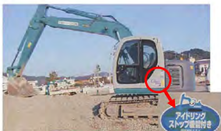
アイドリングストップ機器付き建設機械の採用
