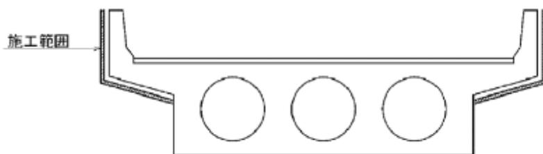
図 5-2-50 剥落防止対策施工範囲図
