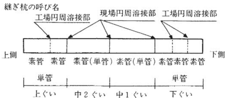
図 4-1-9 継ぎ杭の呼び名図
