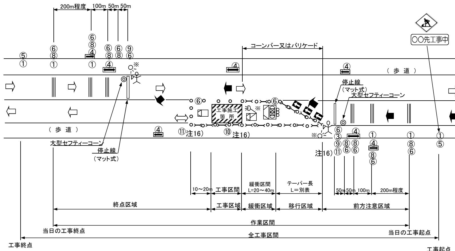
注1) 舗装修繕工事等のように一定の工事区間をもつものは、工事起終点に固定看板（①⑤）を設置する。
