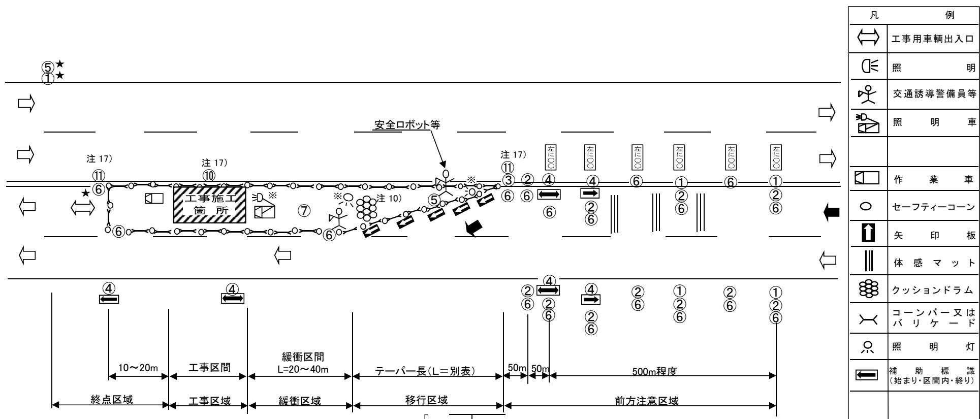
注 1) 標識設置の起終点は、交通の状況により適宜考慮する。
