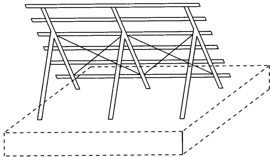
2) 吊柵 ー 固定アンカーを有しワイヤ等で柵を吊っているもの
