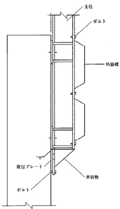
※水切板の設置高さは、施工基面からとする。
