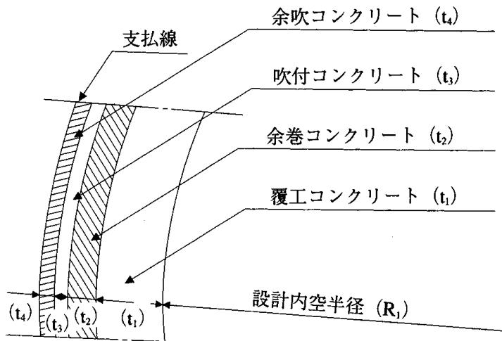
$$\begin{aligned} \text{設計掘削半径} &= \text{設計内空半径} (R_1) + \text{覆工コンクリート厚} (t_1) + \text{吹付コンクリート厚} (t_3) \\ \text{支払掘削半径} &= [\text{設計内空半径} (R_1) + \text{覆工コンクリート厚} (t_1) + \text{吹付コンクリート厚} (t_3)] \\ &\quad + \text{余掘} = \text{設計掘削半径} + \text{余掘} \end{aligned}$$
