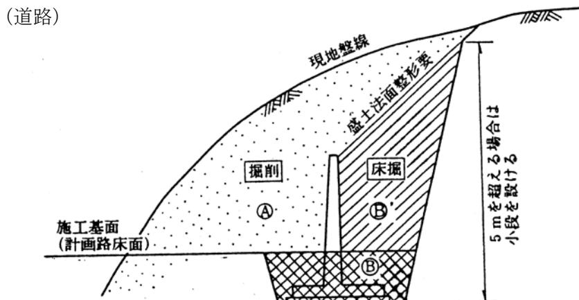
注) 1. B'領域については、実作業は「掘削」行為となるが、数量算出上は、「床掘」として算出するものである。
