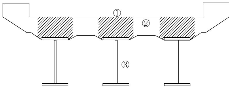
作業順は、①の斜線部を大型ブレーカで1次破碎後、鉄筋をガス切断、②のブロック塊をホイールクレーンで撤去し、③の桁材切断・撤去を行う。
