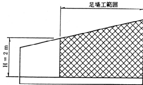
2) 足場面積の算出は、下記のとおりとする。なお、現場条件、構造物の構造および施工方法等でこれによりがたい場合は、別途算出するものとする。
