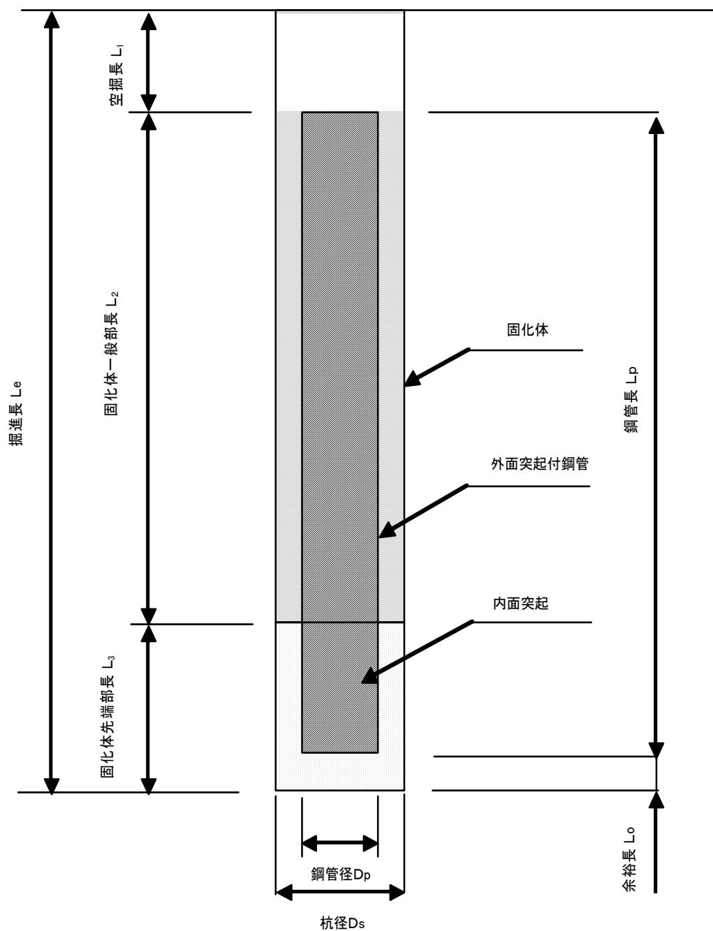
$$\text{掘進長 } L_e = \text{空掘長 } L_1 + \text{固化体一般部長 } L_2 + \text{固化体先端部長 } L_3$$
