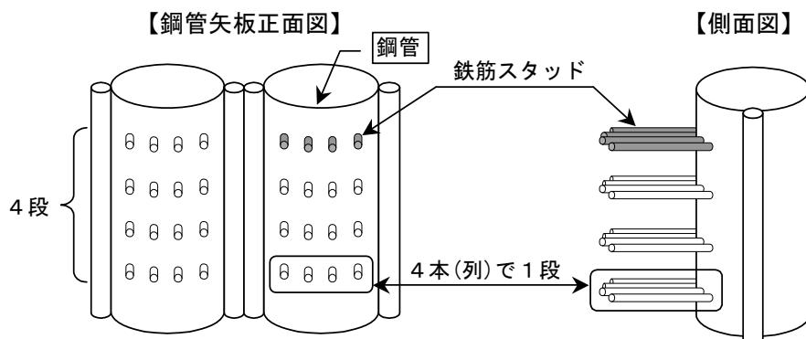
$$\text{例) 鋼管本数 } 20 \text{ 本の場合} \cdots 4 \text{ 段} \times 20 \text{ 本} = 80 \text{ 段} \quad \therefore \text{積算数量} = 80 \text{ 段}$$
