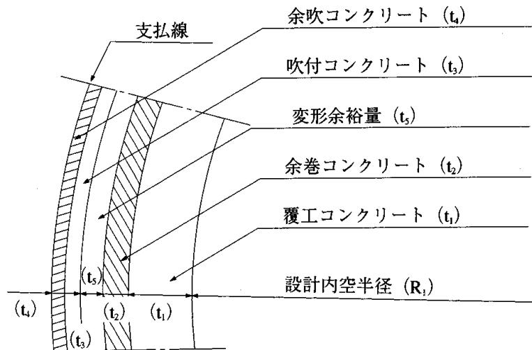
$$\begin{aligned} \text{設計掘削半径} &= \text{設計内空半径} (R_1) + \text{覆工コンクリート厚} (t_1) + \text{吹付コンクリート厚} (t_3) \\ &\quad + \text{変形余裕量} (t_5) \end{aligned}$$
