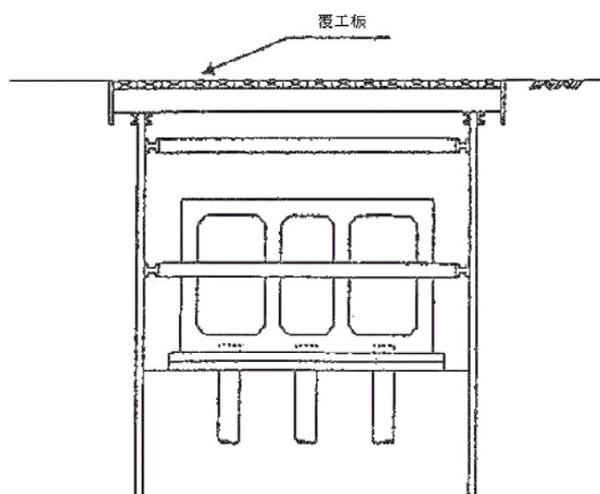
覆工板を外さず作業する…  $T_2$  (地下構造物)
