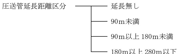
注) 圧送管延長距離区分は、作業範囲（30m）を超えて圧送管を延長する場合に、超えた部分の延長距離を該当する区分から選択する。
