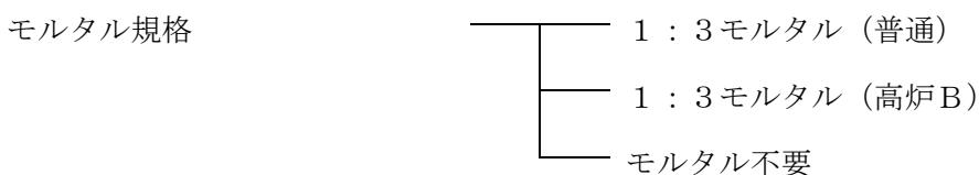
(5) ジョイント処理のモルタル使用量 ( $m^3$ /箇所) による区分は、以下のとおりとする。
