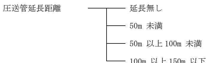
注) 圧送管延長距離区分は、作業範囲(30m)を超えて圧送管を延長する場合に、超えた部分の延長距離を該当する区分から選択する。
