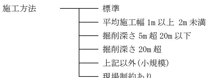
注) 1. 施工方法「上記以外(小規模)」とは、1箇所当たりの施工土量が 100m<sup>3</sup> 程度まで、又は平均施工幅 1m 未満の床掘りで、「1箇所当たり」とは、目的物 1箇所当たりであり、目的物が連続している場合は、連続している区間を 1箇所とする。
