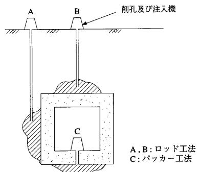
2. 削孔径はロッド工法がφ46mm、パッカー工法がφ52mm（2インチ）を標準とする。
