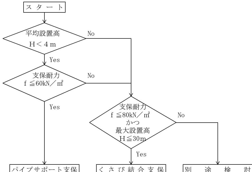
注) 支保耐力  $80 \text{ kN}/\text{m}^2$  を超える場合、又は最大設置高さが  $30 \text{ m}$  を超える場合は、別途工法等を検討するものとする。
