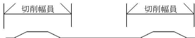
2) 1施工箇所において、全面切削と帶状切削が混在する場合は、全面、帶状ごとに数量を算出する。
