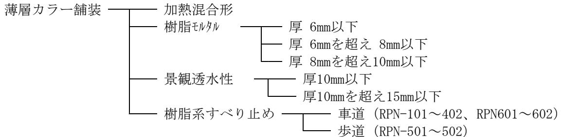
(注) 1. 樹脂系すべり止め舗装の区分は、規格・仕様別に区分して算出する。
