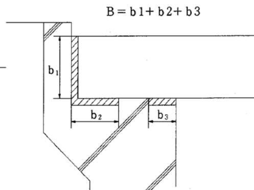
$$A = B \times L \quad A : \text{型枠面積 } (m^2)$$
