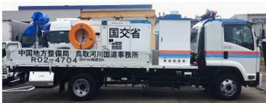
【排水ポンプ車 水中ポンプ4台搭載】
