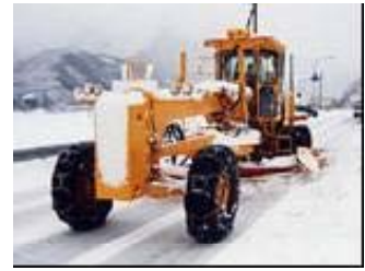
除雪グレーダー ※締め固った雪を取り除く機械
