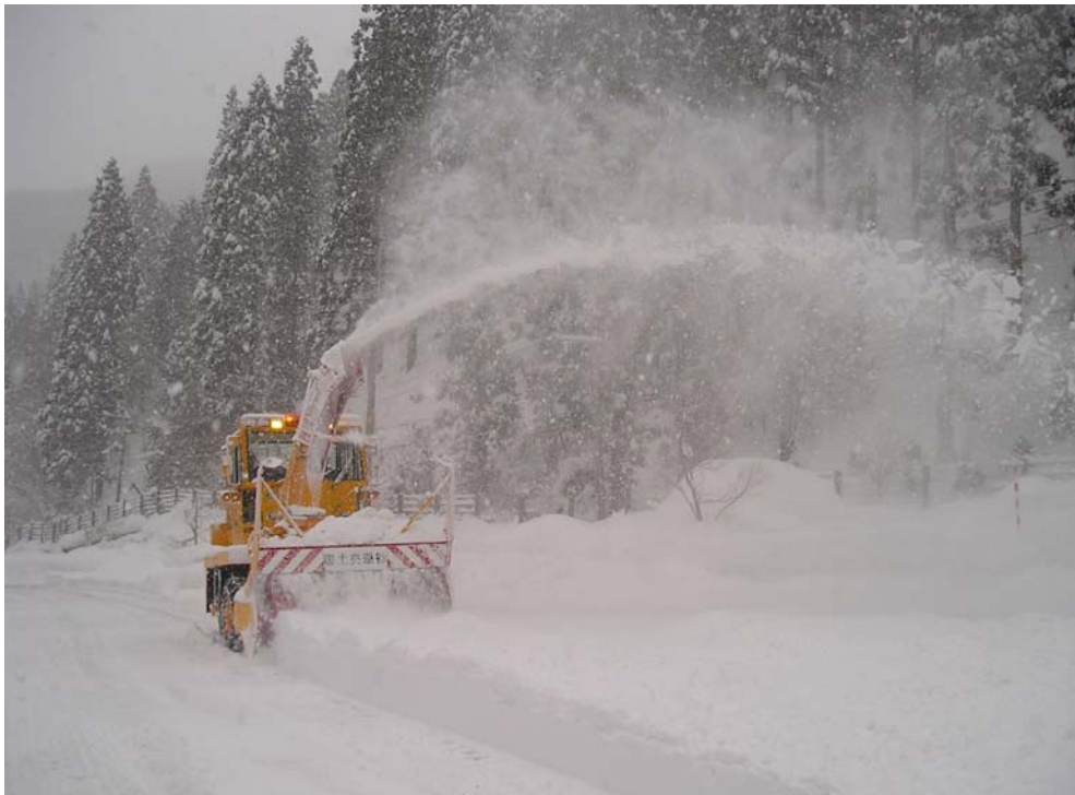
ロータリ除雪車で除雪を行っています。
