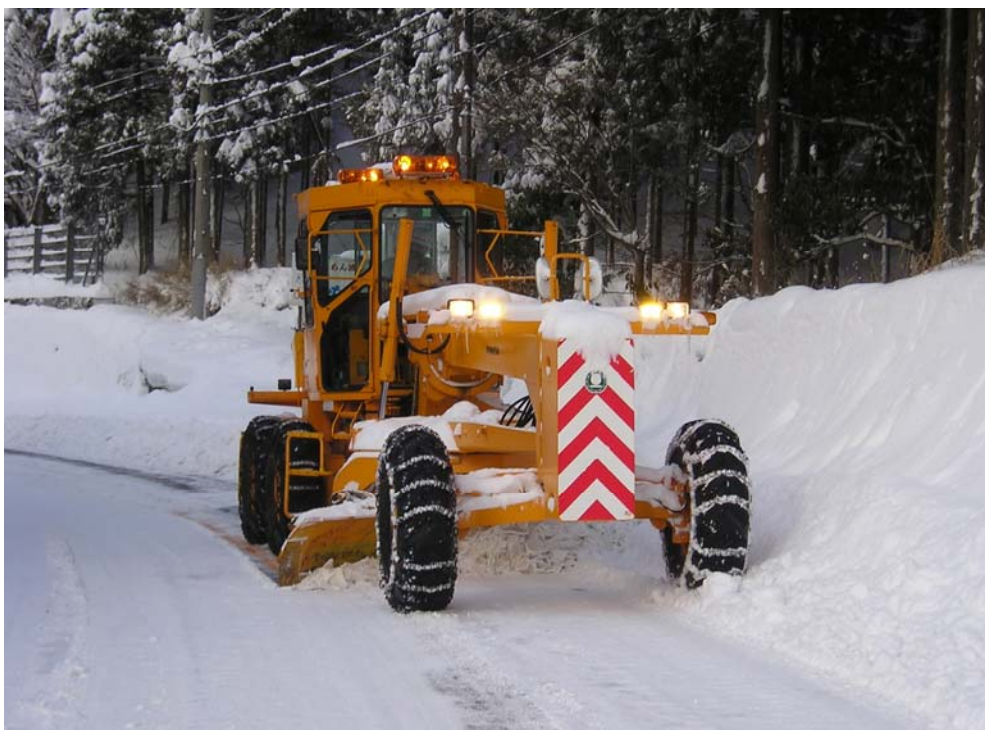
除雪グレーダで除雪を行っています。
