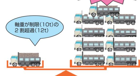
仮に、大型車両1台が、軸重10トンの基準よりも2トン超過した場合は、舗装に対しては約2台分、RC床版に対しては約9台分の疲労が蓄積されることとなります。
