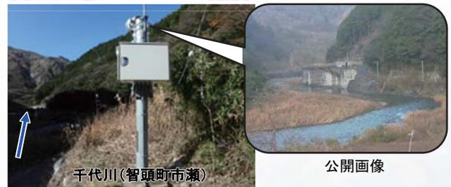
鳥取県では、洪水時などの監視を強化するため、県管理河川73箇所に河川監視カメラを設置していますが、本年度新たに千代川水系では智頭町市瀬(千代川)、若桜町若桜(八東川)にカメラを設置し、画像を公開しています。
