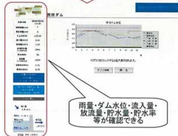
雨量・ダム水位・流入量・放流量・貯水量・貯水率等が確認できる
