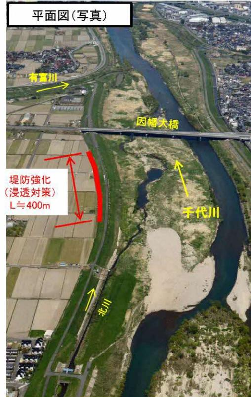
ドレーンを整備することで、堤防内の浸透水位を低くし、堤防の破壊(すべり)を防ぐ
