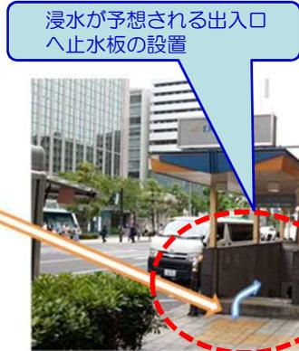
② 浸水シミュレーションにより浸水する出入口の特定と止水板の設置
