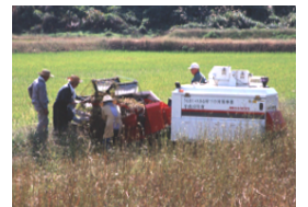
刈り取り作業中、時々機械にそばの茎がからみつき、作業が中断される。
