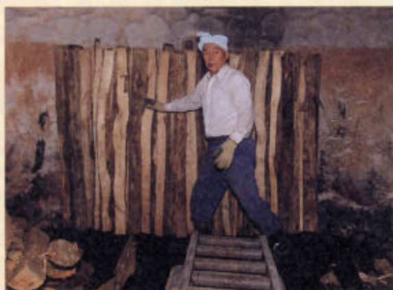
④ 窯の中は意外に広く、一窯で約10〜11トンの木が入り、1トン半の黒炭が仕上がる。
