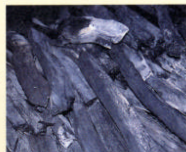
約3日間、日中火を焚き、その後7日間で木が炭化し、10日間窯を冷やし、窯から炭を取り出す。
