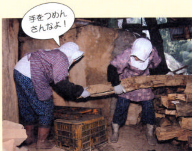
④ 窯の入口から、長さ約4mの鉄製のローラーを窯の奥に突っ込み、小割りにした木をローラーの上で転がしながら奥へ入れる。
