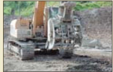
ショベルの部分が編み目状に加工されたショベルカーを使います。
