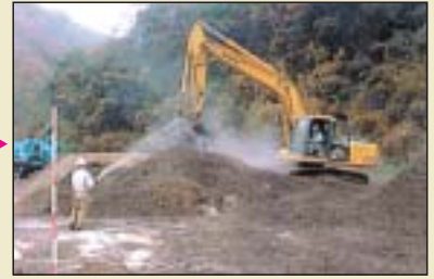
粉末状になった木に、発酵促進剤や尿素などを入れ、堆肥になるよう水をかけながらよく混ぜます。
