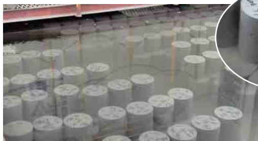
乾燥防止のため、水槽に浸けてある検査用コンクリート。
