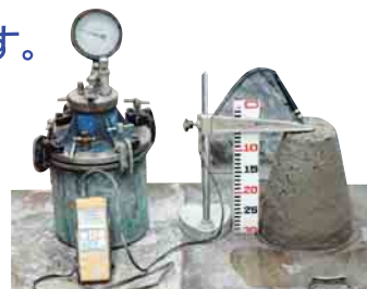
混ぜ合わせたコンクリートの温度、空気の含有率、硬さの度合いを確認する試験。
