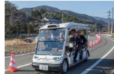
自動運転車両専用レーンの設置 (自動運転レベル4)
