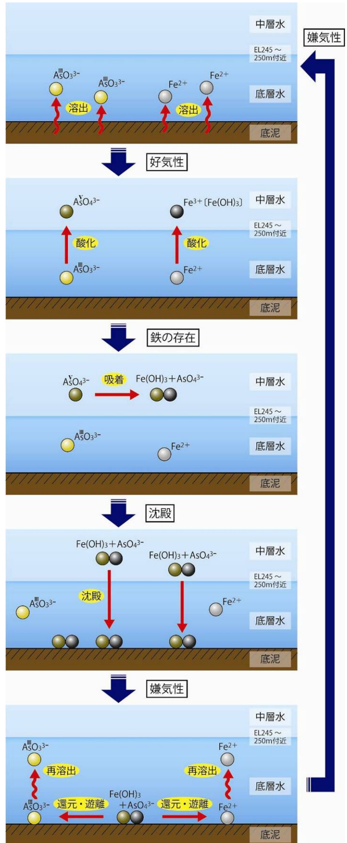
図 1-1 ダム湖底層・底泥におけるヒ素の循環モデル
