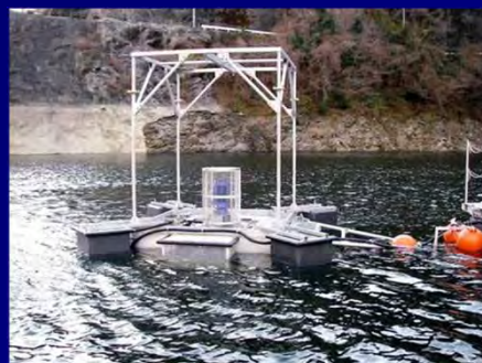
図 プロペラ攪拌式水質改善装置の概念図 (左)／設置状況(右)
