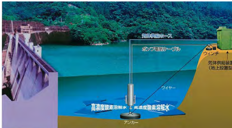
図 1-2 高濃度酸素溶解装置（湖底アンカー式）概念図
