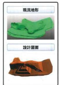
起工測量による3次元測量データ(現況地形)を活用し、設計図面との差分から、適切な施工量を算出。
