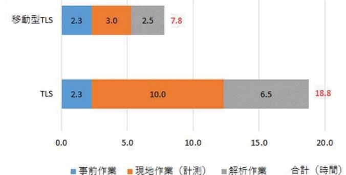
TLSと手押しTLSの比較(時間短縮効果)
