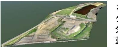
3次元測量点群データと設計図面との差分から、施工量を自動算出
