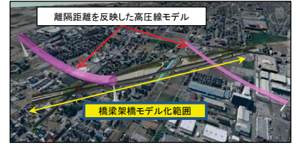
橋梁と架空線の離隔確認
